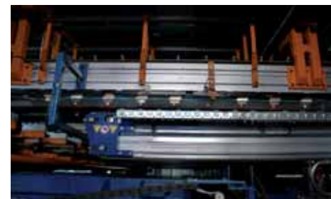
Una de las acciones implantadas para ahorrar energía consiste en que el alimentador de la prensa Erfurt ha dejado de aspirar y soplar en posición de reposo.
